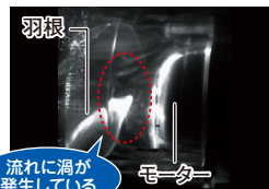
※粒子画像流速測定法(Particle Image Velocimetry)による流れを見える化した画像
