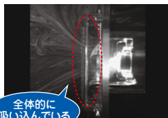
※粒子画像流速測定法(Particle Image Velocimetry)による流れを見える化した画像
