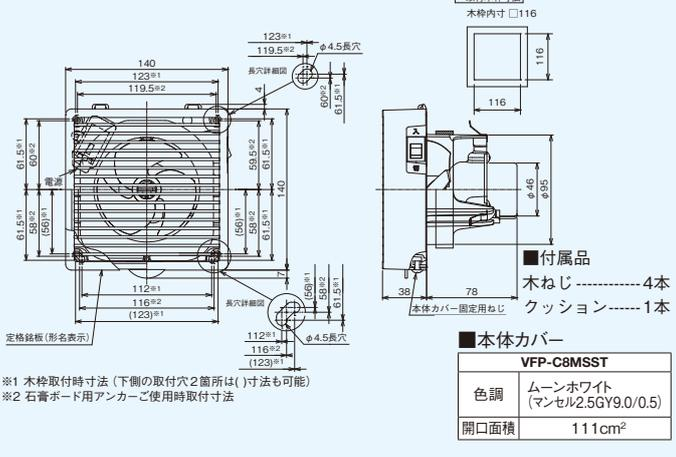
●VFP-C8MSST 静圧-風量特性 抵抗曲線は塩ビVU管φ100の場合
